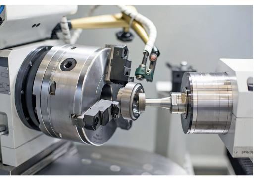
Hochpräzises Innen-, Außen- und Radiusschleifen mit vollautomatischem Werkstückhandling ermöglicht die 'IRD-400' von Danobat-Tochter Overbeck © Danobat
